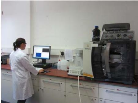
Das Standardverfahren zur Bestimmung der Reaktionsprodukte erfolgt mittels NMR-Messungen. Allerdings werden auch andere Analysemethoden wie HPLC, HPLC-MS und GC-MS genutzt, um die entstandenen Produkte zu charakterisieren. Die Substanzen können anschließend für weitere Forschungszwecke genutzt werden, beispielsweise in der Malaria-Forschung.
